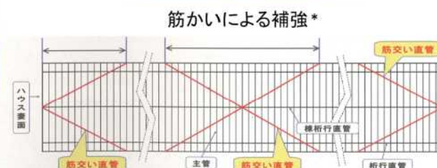
筋交いによる妻面の補強方法事例
