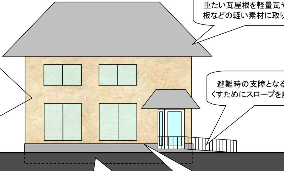
鉄筋の入っていない基礎等に新たに鉄筋の入ったコンクリート基礎で補強する
