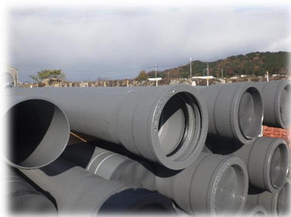
図 2.6.9 ダクタイル鉄管 GX形 250
