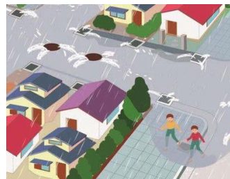
側溝・マンホールからの溢れだし
