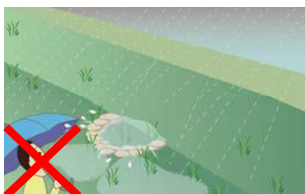
堤防近辺からの漏水・噴砂
