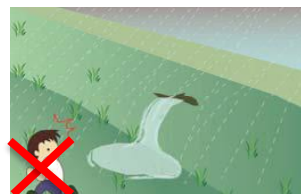
堤防の亀裂・漏水
