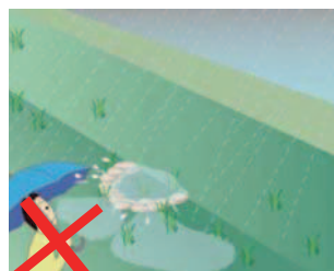
堤防近辺からの漏水・噴砂
