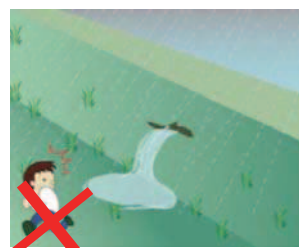
堤防の亀裂・漏水
