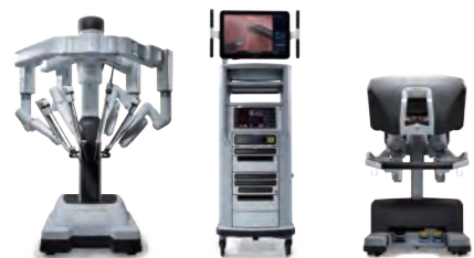
手術支援ロボット「ダビンチ xi」は、患者さんへの身体的負担が少なく、複雑な手術を可能にした最新型のロボットで、3つの機器から構成されています。
