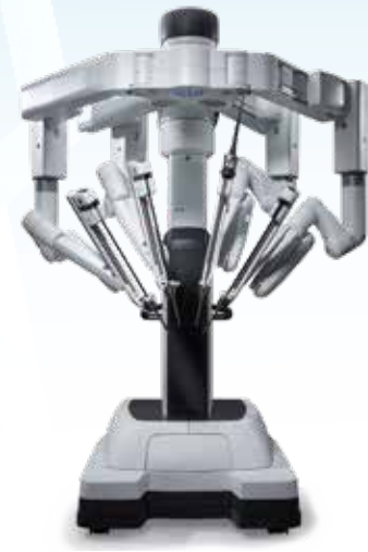
②ペイシェントカート (4本のロボットアーム)
